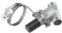
Fig. 27 PV Compact regulator Wavin nr. 0621793 Funktion: Reducerer og fastholder differenstrykket i installationen.
